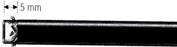
B) Inserire il cavo scaldante nel cappuccio pre-isolato **(8)**.
