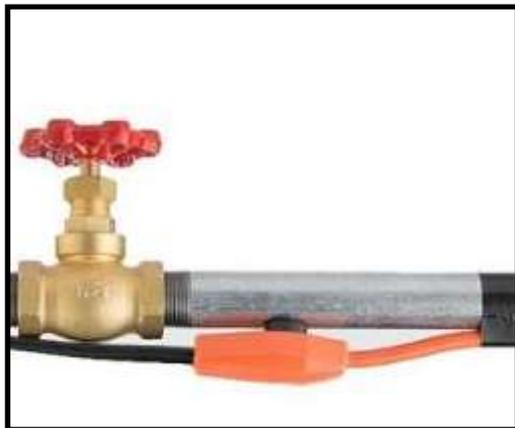
I circuiti scaldanti PT-SR sono costituiti da un cavo autoregolante atto ad evitare il congelamento dell'acqua all'interno di tubazioni, cablato con un termostato che ne regola il funzionamento al solo abbassamento della temperatura rilevata e con un cavo d'alimentazione completo di presa Schuko. I circuiti PT-SR rappresentano una valida ed economica alternativa ai tradizionali metodi di riscaldamento.
