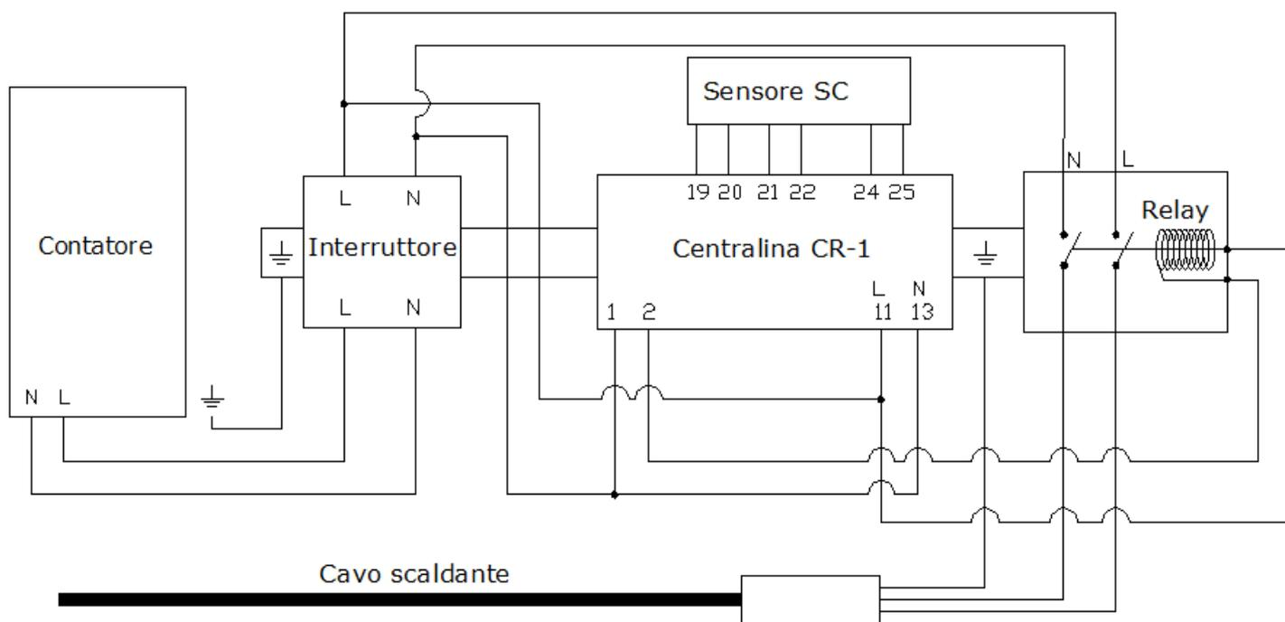
Il cavo scaldante deve sempre essere protetto da un interruttore magnetotermico differenziale 30mA dimensionato in funzione dell'assorbimento del cavo (vedi caratteristiche tecniche)
