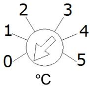
Trimmer per la regolazione del set point della temperatura al di sotto del quale il sistema scaldante viene attivato. Normalmente 4°C
