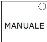
Consente di far funzionare il sistema scaldante escludendo i sensori. Quando il led è acceso i sensori sono esclusi ed il riscaldamento è attivato per un numero di ore pari a quelle impostate tramite l'apposito trimmer, in caso contrario l'attivazione verrà effettuata all'abbassamento della temperatura e se abilitata, alla presenza di umidità
