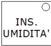
Permette di abilitare o disabilitare il funzionamento basandosi sul valore di umidità rilevata. Se il led è acceso il sistema si basa sia sulla temperatura che dell'umidità rilevata, in caso contrario il riscaldamento verrà attivato al solo abbassamento della temperatura
