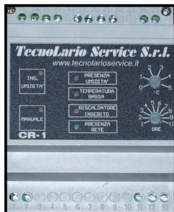
CR-1 è una centralina progettata per il risparmio energetico di impianti scaldanti a protezione antighiaccio ed antineve di superfici calpestabili esterne e di tetti e grondaie. Il ghiaccio si forma per la combinazione di bassa temperatura ed umidità. CR-1 rileva temperatura ed umidità ed attiva il sistema scaldante solo quando il ghiaccio è effettivamente presente.
