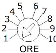
Trimmer per l'impostazione delle ore di funzionamento nei seguenti casi:
